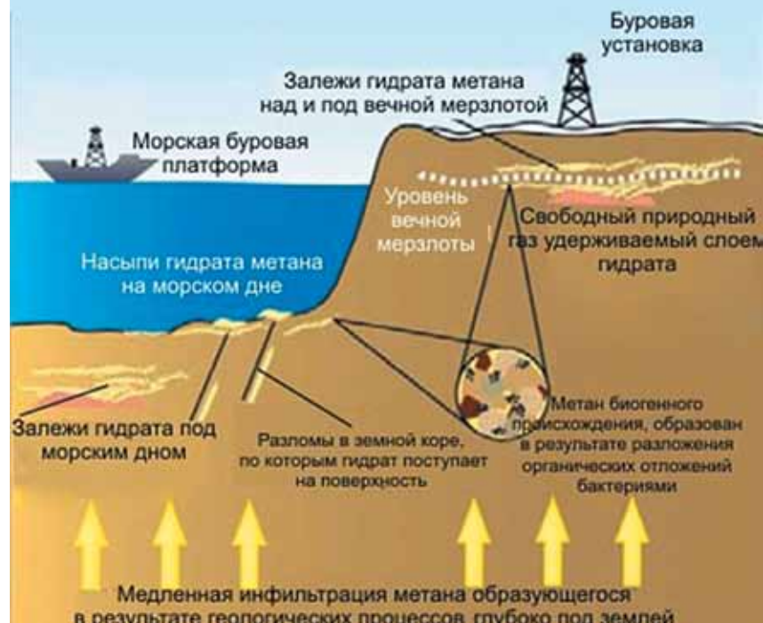
Схема образования гидрата метана
